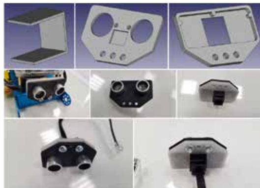
Рис. 5. Примеры напечатанных деталей: элементы защиты датчиков
