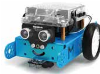
Рис. 2. Базовый робот mBot
