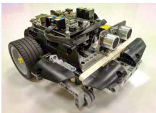
Рис. 4. Вариант шасси робота на базе ресурсного набора Lego Mindstorms EV3 (45560). Контроллер от MakeBlock может быть заменен на Arduino
